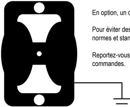
En option, un câble de mise à la terre de 244 centimètres (8 pieds) de long permet une mise à la terre aisée.
