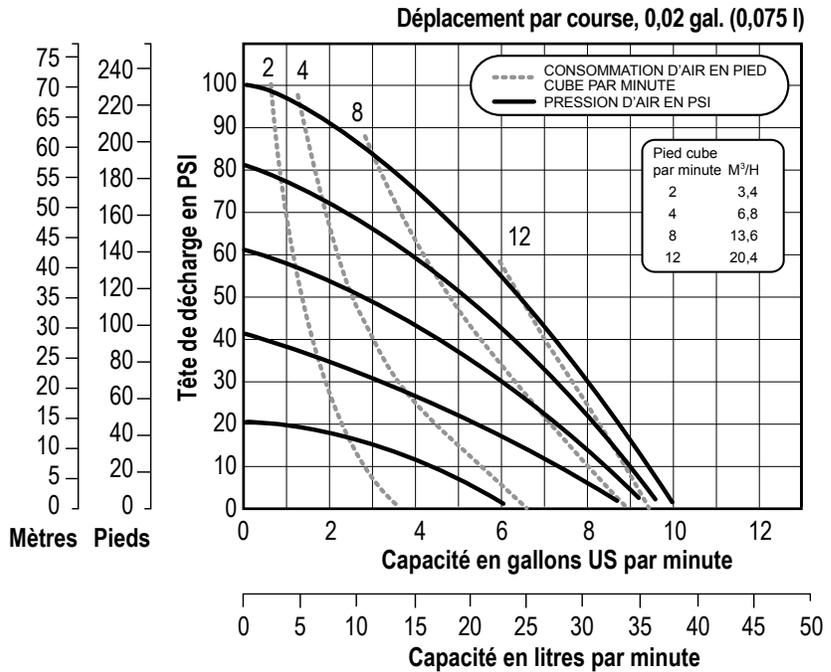
REMARQUE : Performances évaluées sur la base des caractéristiques suivantes : pompe équipée PTFE, aspiration immergée, eau dans des conditions ambiantes. L'utilisation d'autres matériaux et des conditions hydrauliques diverses peuvent entraîner des écarts de plus de 5 %.
