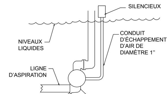
La pompe peut être immergée si les matériaux de construction de la pompe sont compatibles avec le liquide pompé. L'orifice d'échappement de l'air doit être positionné au-dessus du niveau du liquide. Lorsque la source du produit pompé se trouve à un niveau supérieur que celui de la pompe (condition d'aspiration immergée), placez l'orifice d'échappement au-dessus de la source du produit pour éviter tout déversement par siphonnage.
