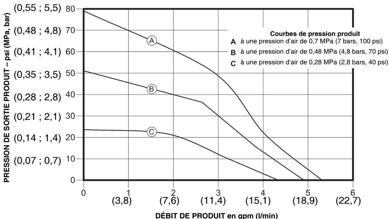
**Pour connaître la pression de sortie du produit de pulvérisation (MPa/bars/psi) à un débit de produit spécifique (l/min ou gpm) et une pression d'air de service spécifique (MPa/bars/psi) :**
